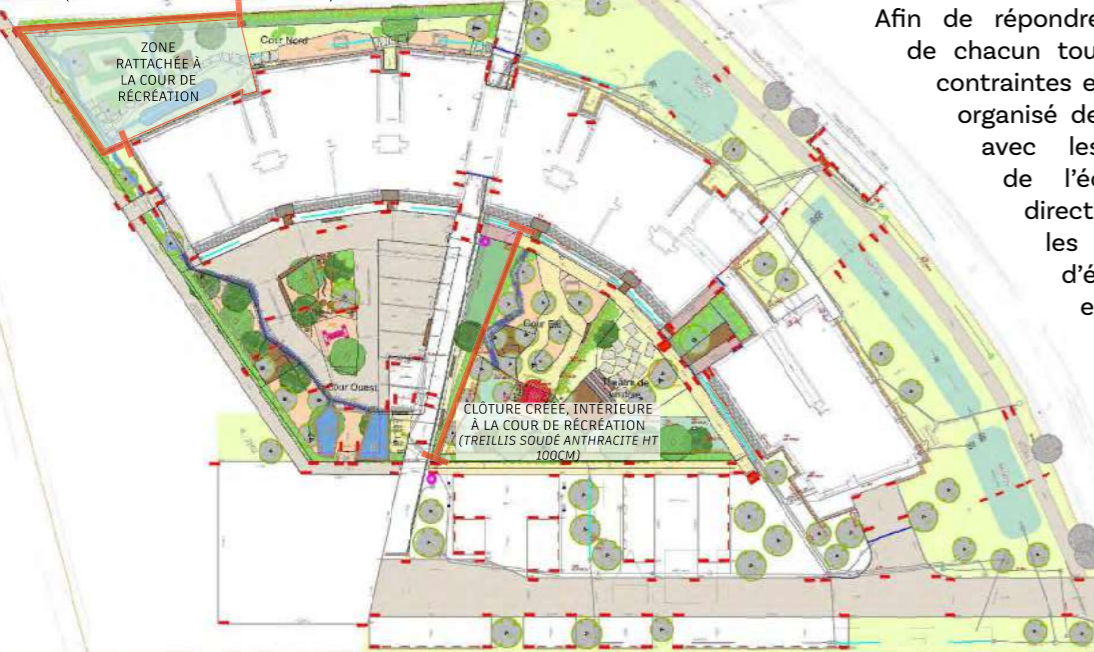
CLÔTURE CRÉÉE - PROLONGATION DE LA CLÔTURE EN VUE DE L'AGRANDISSEMENT DU PÉRIMÈTRE DE L'ÉCOLE (TREILLIS SOUDÉ ANTHRACITE HT 160CM)
